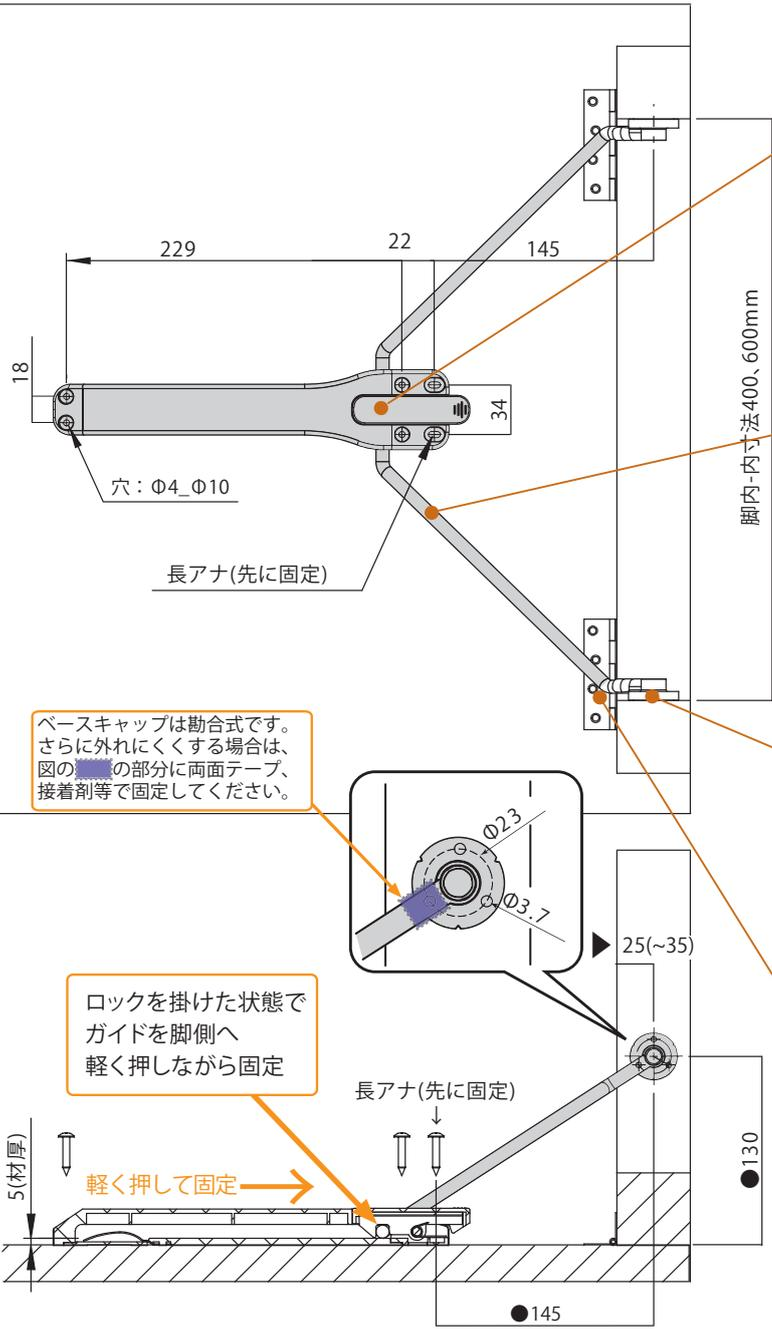
※長アナに固定の際に、ガイドを脚側へ軽く押しながら固定しますとクリアランスが減り、テーブル使用時にガタツキを減らし、より安定感が得られます。
